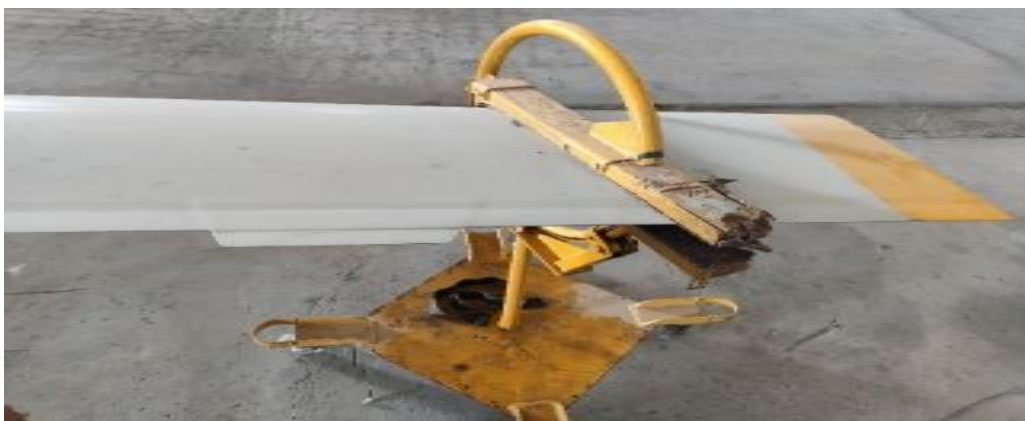
ملخ هلیکوپتر در وضعیت خراب تنظیم و در حال رفع گیر ارتعاش
