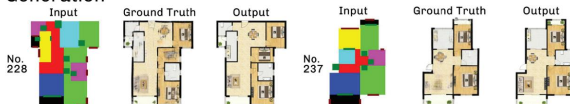
شکل ۲. تشخیص و تولید طرح طبقه آپارتمان با استفاده از cGANs [۵].
