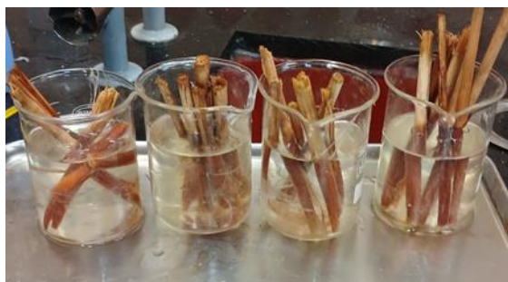
شکل ۱- قرار دادن برش ساقه در محلول سدیم هیدروکسید
