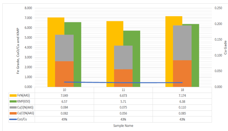
شکل ۶- تغییرات عیار مس، مس اکسید، نسبت مس اکسید به کل، آهن و فاکتور KMP در مقطع DD'
