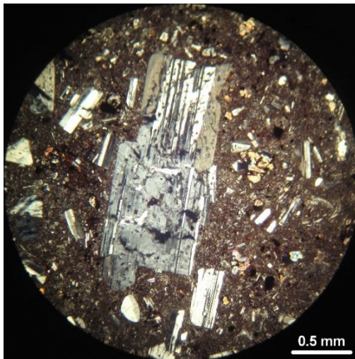
شکل ۴. راست) محدوده قرارگیری نمونه‌های سنگ ولکانیکی بر اساس نمودار وینچستر و فلوید (Winchester and Floyd, 1977)؛ چپ) درشت بلور خود شکل فلدسپار با ماکل پلی‌سینتیک در زمینه عمدتاً شیشه‌ای در نور پلاریزه متقاطع
