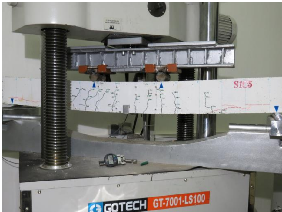
شکل ۱- بارگذاری چهار نقطه ای تیرها [16]
