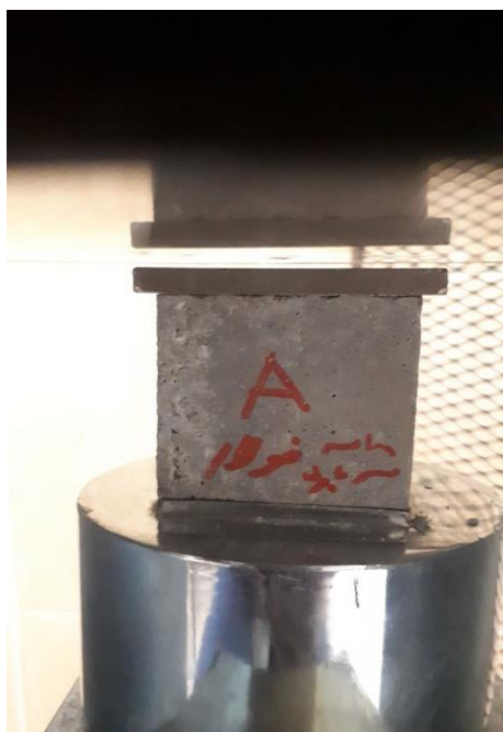
شکل ۷-۳: نمونه شماره دو مکعبی ماسه سرباره (فولر) +سیمان (۲۸ روزه)
