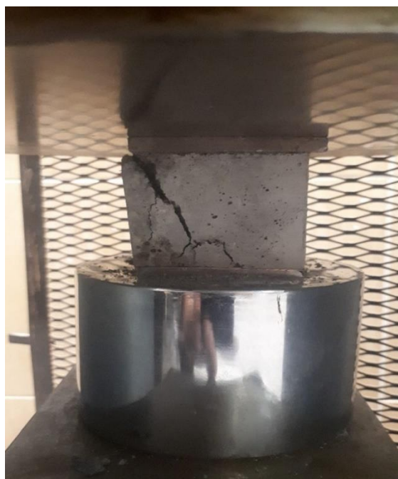
شکل ۶-۳: نمونه شماره دو مکعبی ماسه سرباره (فولر) +سیمان (۷ روزه)
