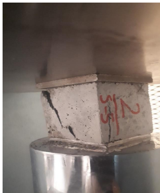
شکل ۶-۳: نمونه شماره دو مکعبی ماسه سرباره (فولر) +سیمان (۷ روزه)
