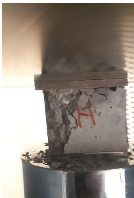
شکل ۷-۳: نمونه شماره دو مکعبی ماسه سرباره (فولر) +سیمان (۲۸ روزه)
