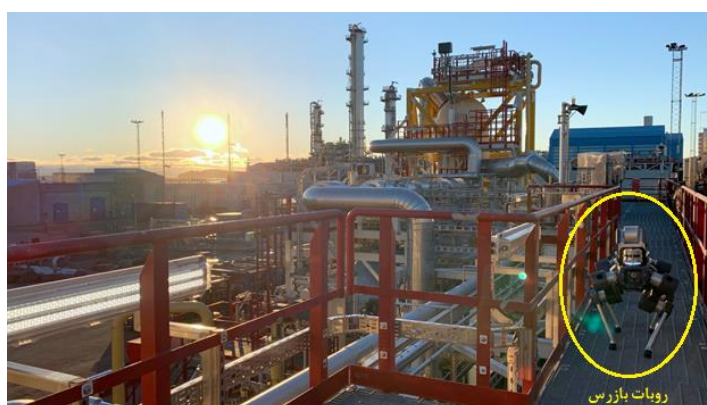
شکل 4 - روبات بازرس ANYmal استفاده شده در تاسیسات نفتی [26]
