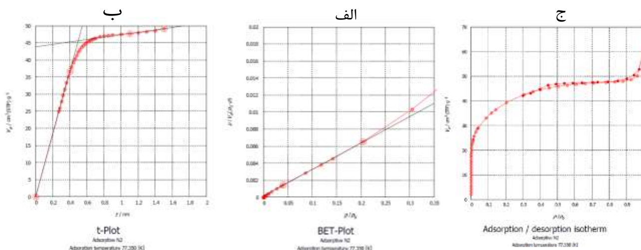
شکل-۲: الف. نمودار BET برای تعیین سطح ویژه نمونه زیرکونیا. ب. نمودار t-plot توزیع اندازه‌ی حفرات نمونه زیرکونیا. ج. ایزوترم جذب/واجذب نیتروژن نمونه زیرکونیا
