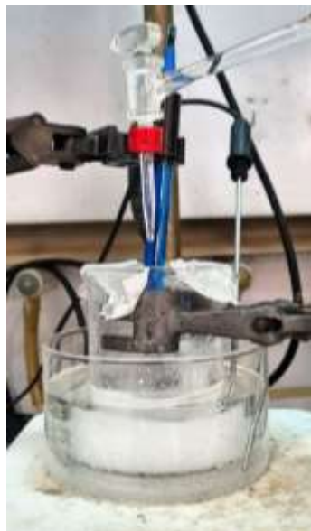
شکل-۱: شماتیکی از رسوب دهی زیرکونیوم به وسیله افزودن آمونیاک و پایش pH
