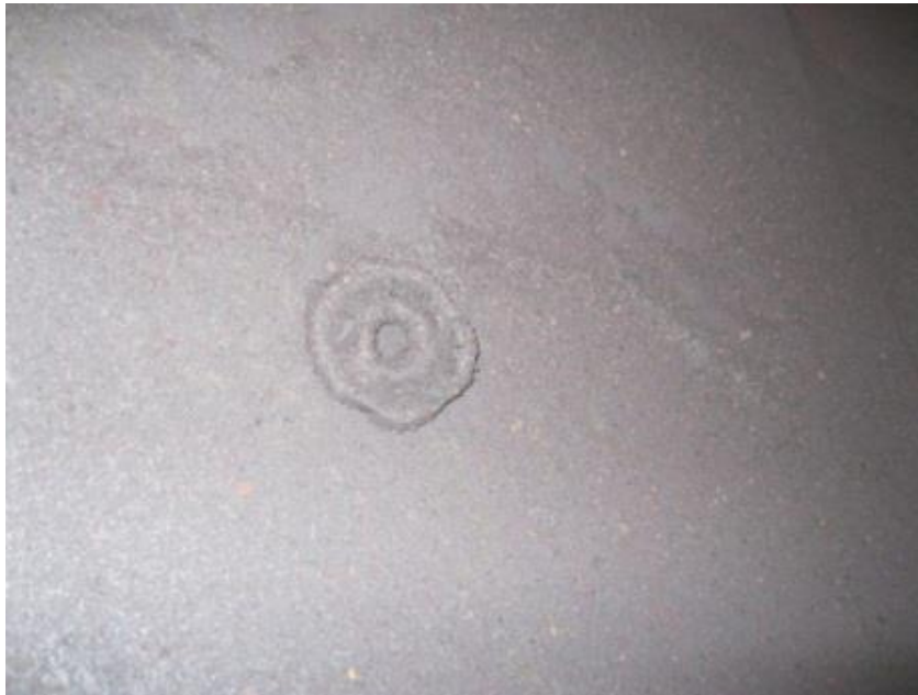
شکل 7: نمونه رسوب تشکیل شده در توربین واحد 2 نیروگاه خرمشهر جدول 1: آنالیز پودر های سیاه. نتایج نشان دهنده حجم بالای عنصر آهن در پودرهای سیاه است.
