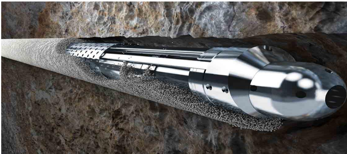
شکل (1) نمایی از لوله مشبک کاری شده در سازند
