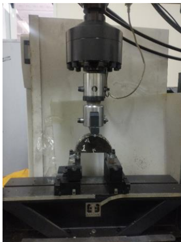
شکل ۸- نحوه قرارگیری نمونه نیم‌دایره‌ای و اجرای آزمون خمش سه‌نقطه‌ای
