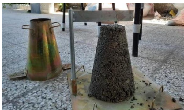
شکل ۳- انجام آزمایش اسلامپ [۳۳]
