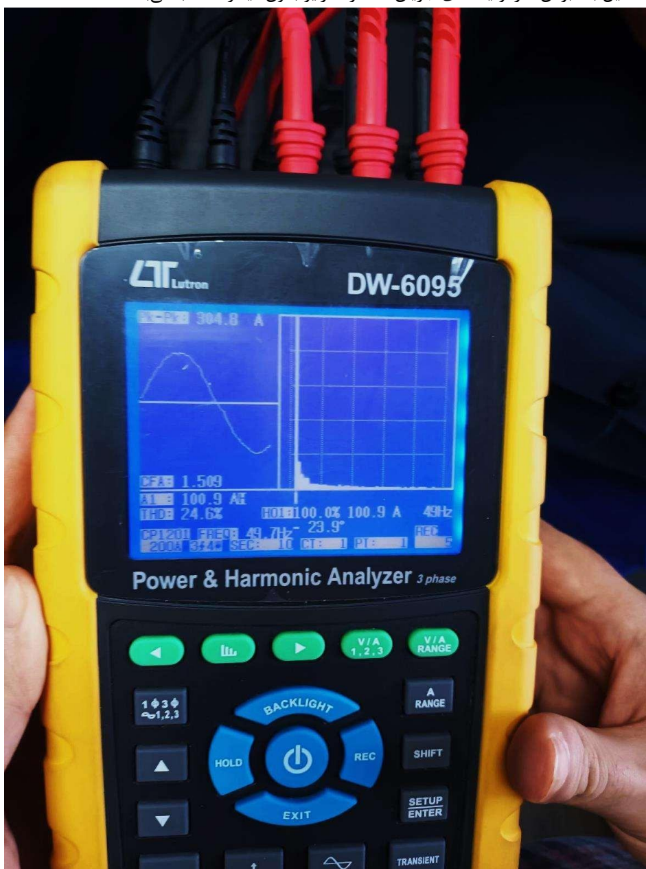
شکل ۸ - تاثیر هارمونیک ها بر شکل موج سینوسی جریان الکتروفن (عکس از صفحه پاور آنالایزر گرفته شده است)
