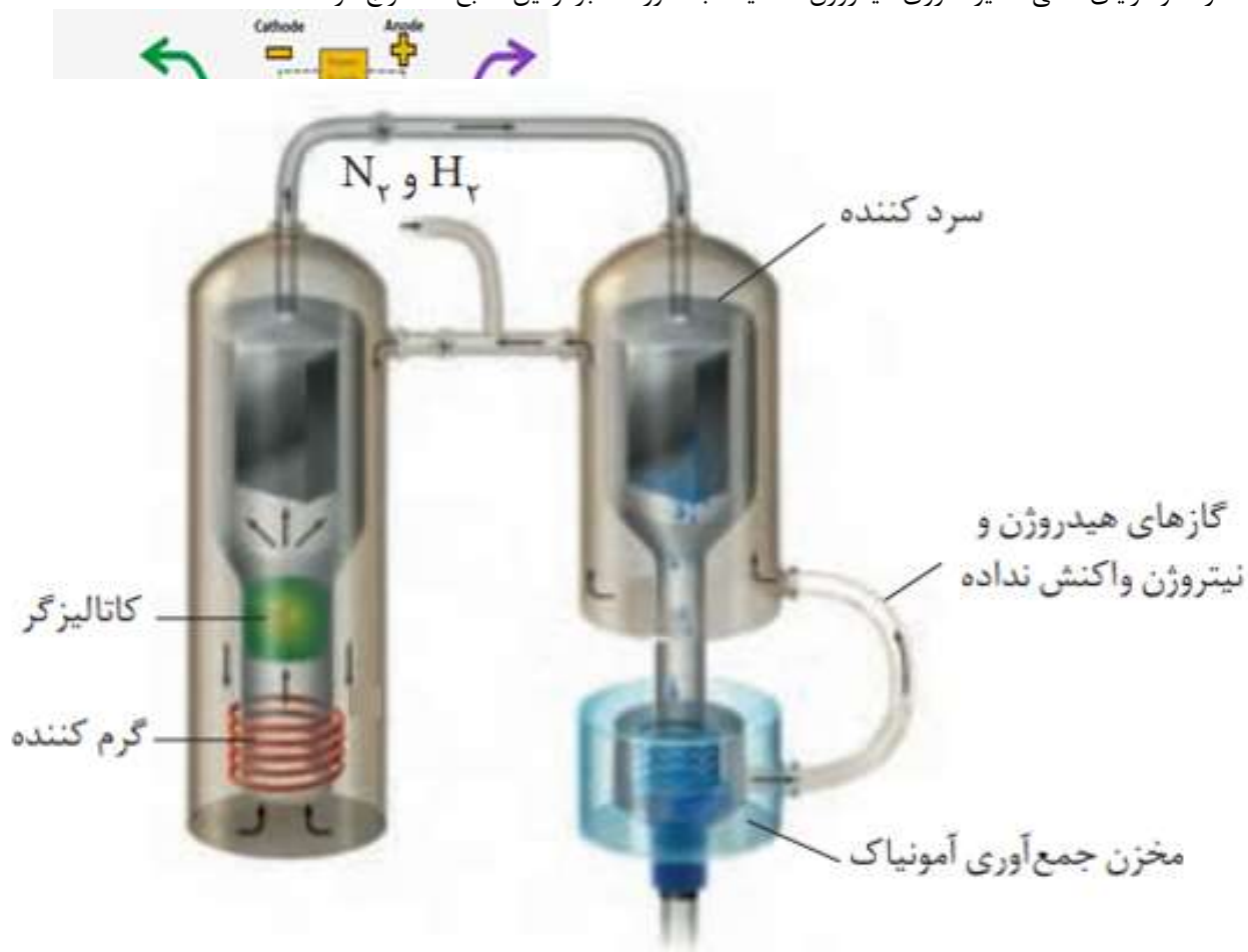
شکل شماره ۷- تولید آمونیاک از هیدروژن
