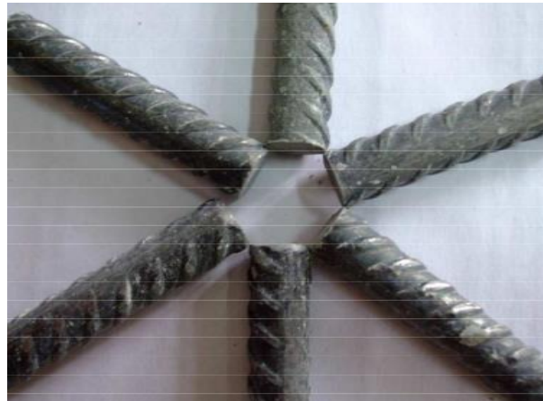
ج) میلگرد مدفون شده در بتن با ۰.۵٪ استنارات کلسیم شکل ۱۳ - وضعیت میلگردهای در شرایط خوردگی متفاوت
