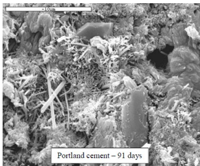
شکل ۲- ساختار نمونه ساخته شده از سیمان پرتلند ۱۰۰٪ [۱۵]
