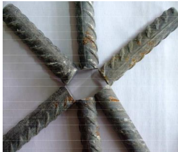
الف) میلگرد خورده شده در نمونه کنترل
