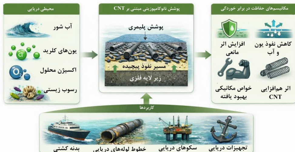
شکل ۱- شماتیک مفهومی مکانیسم‌های حفاظت در برابر خوردگی پوشش‌های نانوکامپوزیتی مبتنی بر نانولوله‌های کربنی در محیط‌های دریایی
