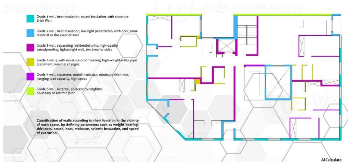
شکل ۱۷ الویت دهی و تفکیک دیوار ها جهت برنامه ریزی اجرایی
