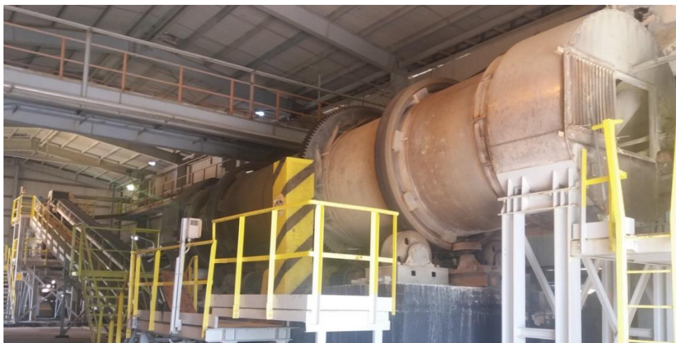
شکل ۴ - سیستم گرانول سازی (گرانولاتور) ۲ B-200-08
