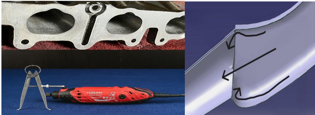
شکل ۱- سمت راست: انحراف مسیر هوا در مدل مچ نشده اندازه های پورت سر سیلندر و منیفولد، سمت چپ: دستگاه ها استفاده شده برای اصلاح پورت و منیفولد پورت مچ شده.
